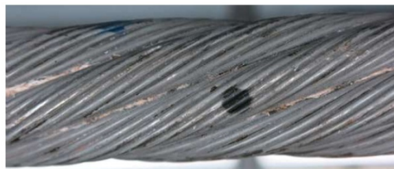
Рисунок 4-14: Обрыв жилы размером 0,5 диаметра пряди
