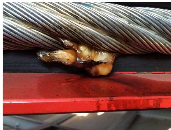
Рисунок 2-7: Повреждения из-за прохождения тока
