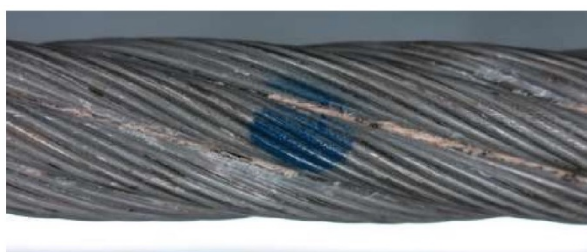
Рисунок 4-6: Повреждение от удара молнии размером 1,0 диаметр пряди
