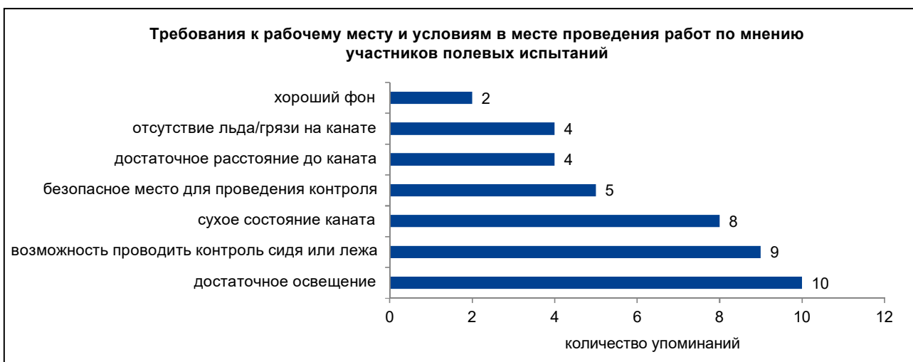
Рисунок 5-5: Требования к рабочему месту и условиям в месте проведения работ по мнению участников полевых испытаний
