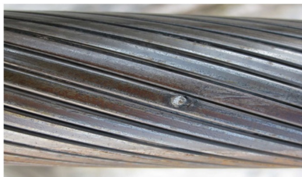
Рисунок 2-13: Удар молнии по закрытому канату
