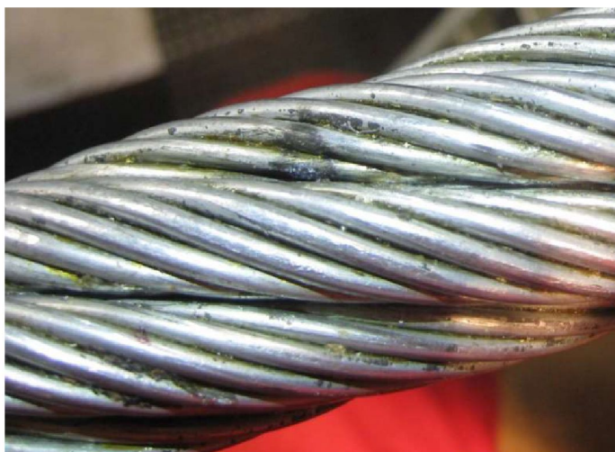
Рисунок 4-1: Голубоватое обесцвечивание в результате удара молнии
