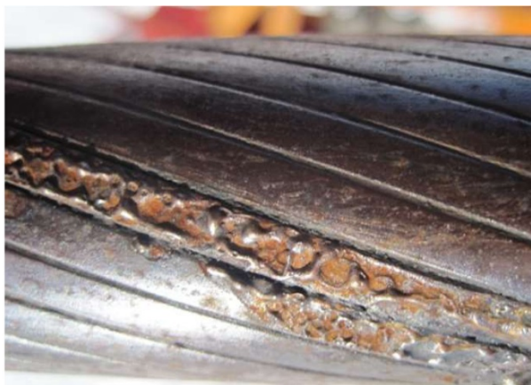
Рисунок 2-11: Удар молнии по закрытому канату
