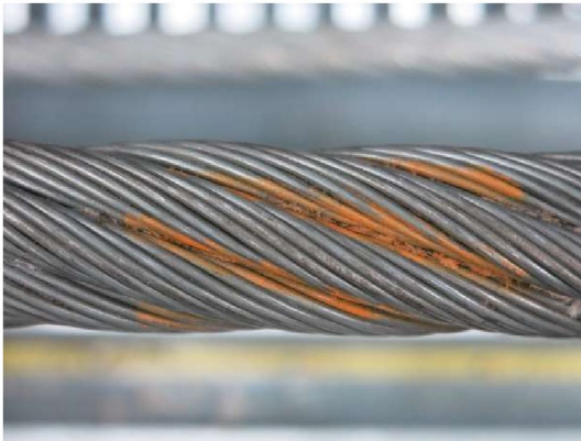
коррозия в углублении пряди
