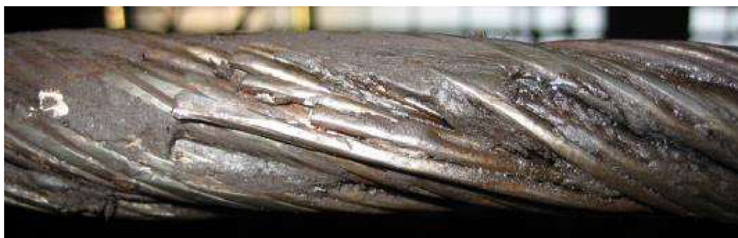
Рисунок 13: Очень грязный канат - контроль невозможен!
