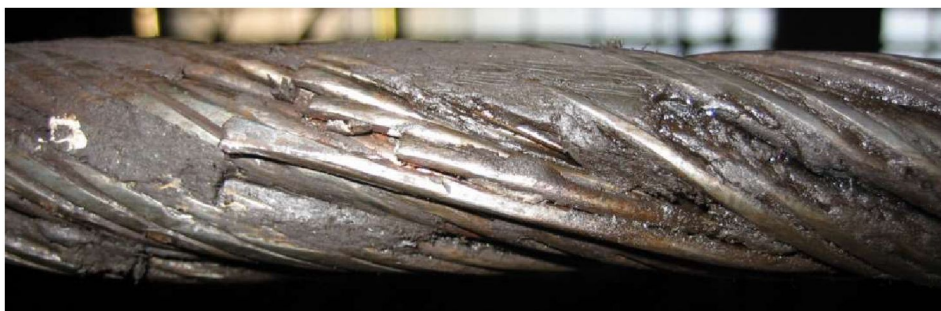
Рисунок 6-13: Сухой канат - контроль невозможен
