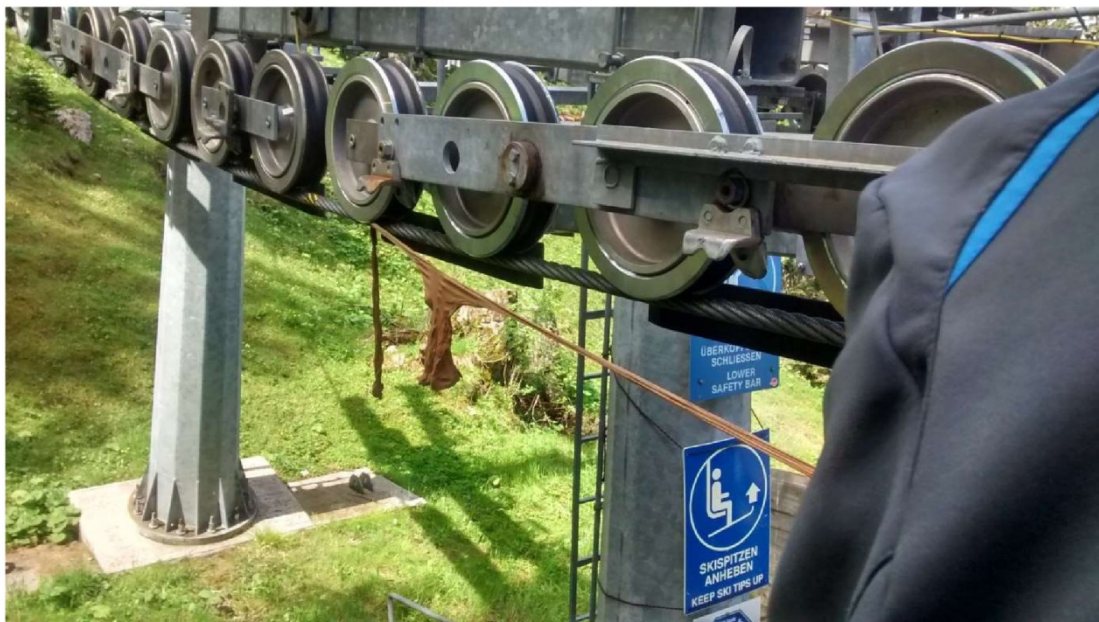
Рисунок 5-19: Нейлоновый чулок зацепляется за канат и втягивается в роликовый блок
