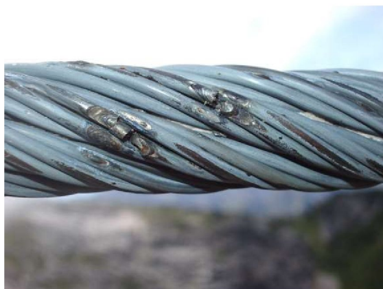
Рисунок 4-2: Мартенсит с оплавленными жилами
