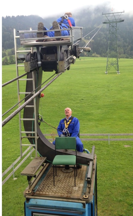
Рисунок 5-28: Стулья на кабине во время визуального контроля
