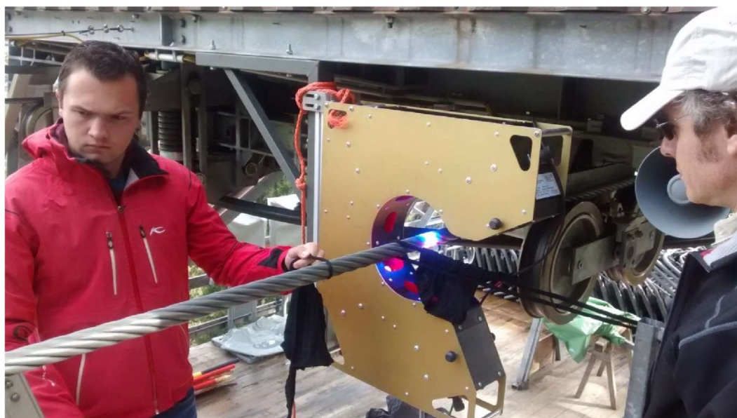
Рисунок 5-18: Контроль с помощью нейлонового чулка
