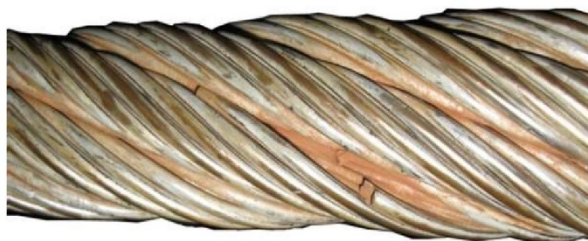
Рисунок 4-17: Коррозия зоны контакта прядей (с обрывами жил)
