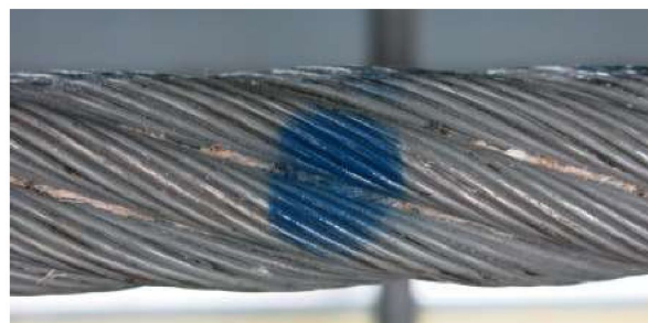
Рисунок 4-5: Повреждение от удара молнии размером 1,5 диаметра пряди
