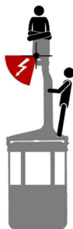
Рисунок 6-11: Неудачное положение при контроле направляющего каната. Около 45° окружности каната остаются вне поля зрения
