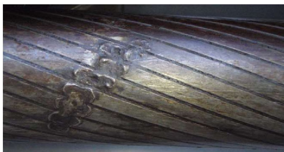
Рисунок 2-15: Точка выхода с боковой стороны каната
