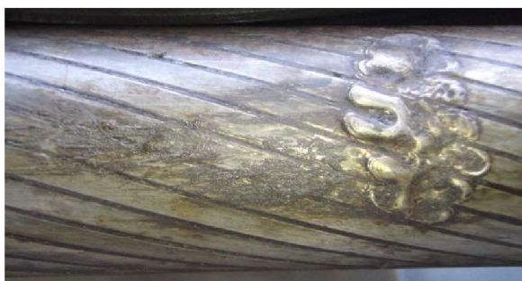
Рисунок 2-14: Точка воздействия с нижней стороны каната
