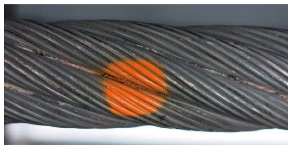
Рисунок 4-22: Коррозия размером 1,5 диаметра пряди
