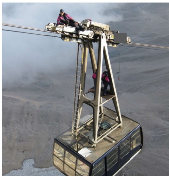
Рисунок 3-9: Визуальный контроль направляющих канатов с платформы и тележки
