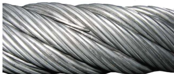
Рисунок 4-9: Обрыв жилы с выступающей жилой
