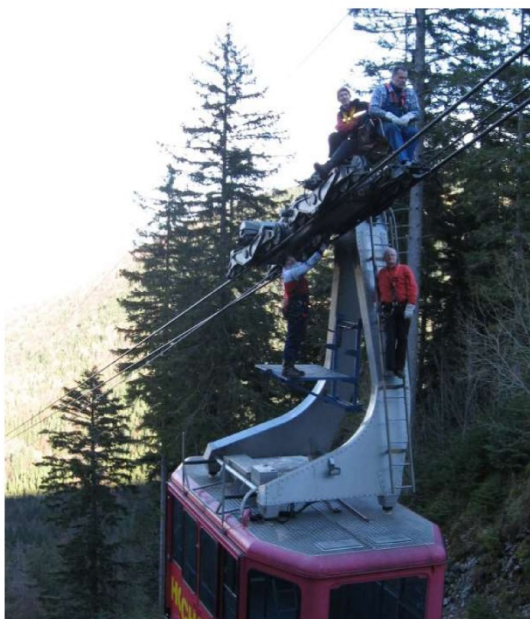
Рисунок 3-8: Визуальный контроль направляющих канатов с лестницы, платформы, стула и тележки
