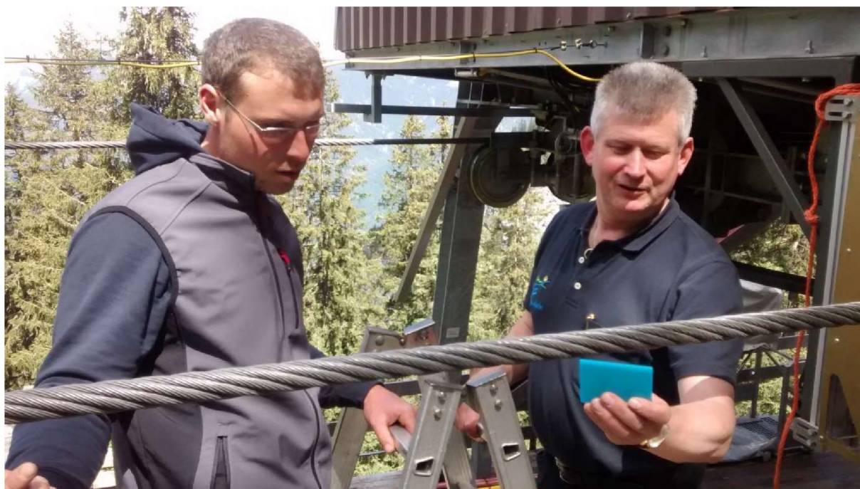
Рисунок 5-22: Контроль с применением ручного зеркала
