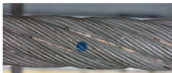
Рисунок 4-7: Повреждение от удара молнии размером 0,5 диаметра пряди
