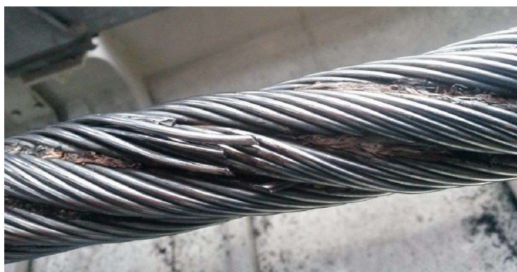
Рисунок 2-3: Сжатие заправленных хвостовых концов с обрывом нескольких жил
