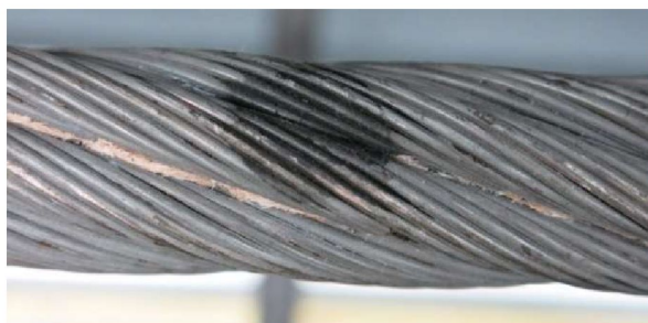
Рисунок 4-4: Повреждение от удара молнии размером 1,5 диаметра пряди
