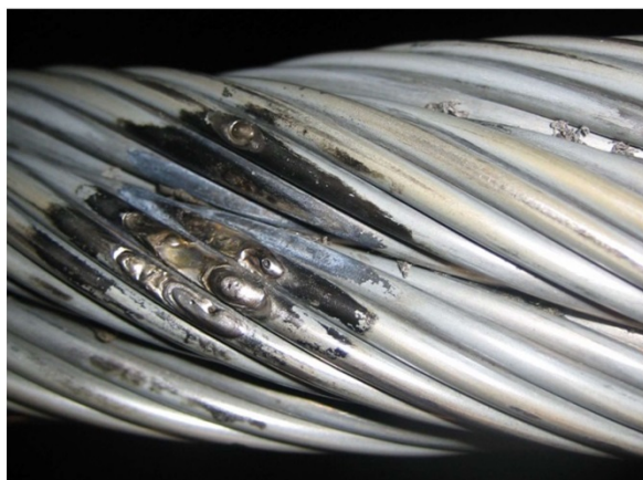
Рисунок 2-10: Удар молнии по многопрядному канату
