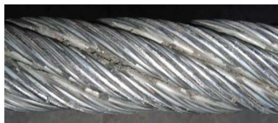
Рисунок 4-26: Засечки на тяговом канате
