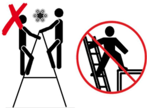
Рисунок 9: Не рекомендуемое использование лестниц
