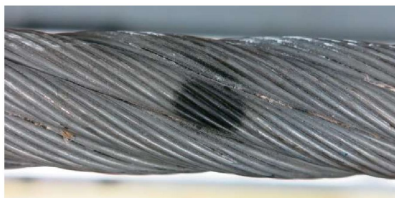
Рисунок 4-15: Обрыв жилы размером 1,0 диаметр пряди
