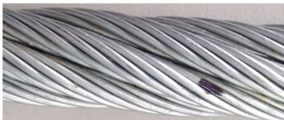
Рисунок 4-13: Обрыв единичной жилы в зоне контакта прядей
