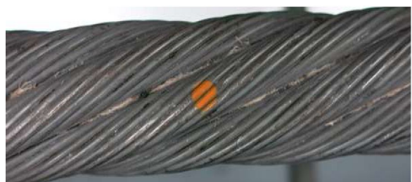
Рисунок 4-24: Коррозия размером 0,5 диаметра пряди
