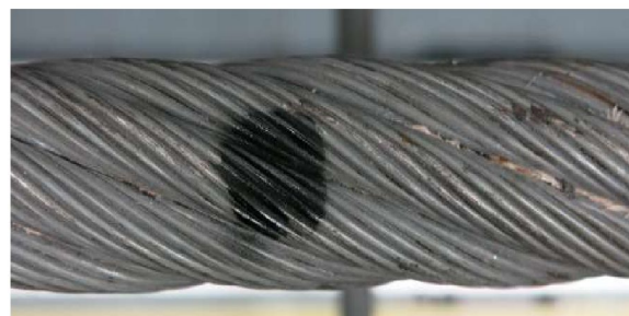
Рисунок 4-16: Обрыв жилы размером 1,5 диаметра пряди
